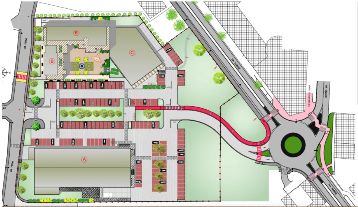
Nel progetto approvato dal Consiglio comunale c'è la realizzazione di una palazzina residenziale di 5 piani fuori terra più un piano terra commerciale con piano interrato per parcheggio (edificio B), la realizzazione di un edificio commerciale adiacente la palazzina residenziale (edificio C) e di un terzo edificio commerciale di 1804,25 mq nella parte sud del lotto (edificio A).
