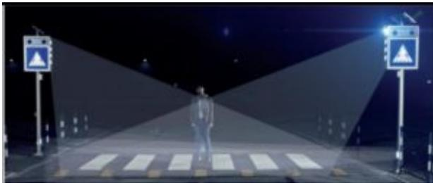
Lo strumento è composto da un sistema luminoso che **segnala il passaggio dei pedoni** attraverso l’utilizzo di lampade a led lampeggianti. È inoltre dotato di un sensore che segnala la presenza del pedone e un sistema di comunicazione radio. Le lampade entrano in funzione solo quando viene rilevato un pedone; l’impianto radio permette l’accensione delle sorgenti luminose anche sull’altra parte della carreggiata.
